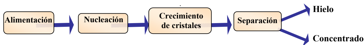
Figura.2.9.- Esquema de las fases del proceso de concentración por congelación
